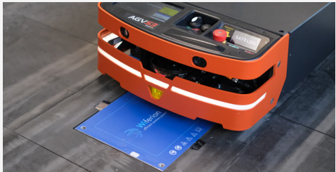
Ladeplatte (induktives Laden)
