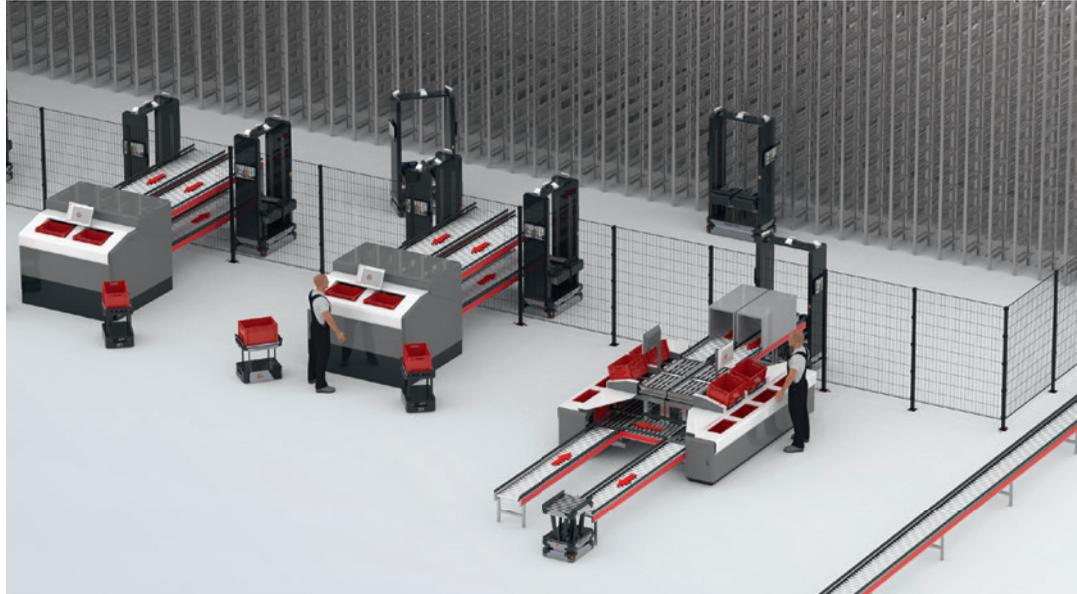
Die Übergabehöhen des Systems sind flexibel einstellbar, um sich an verschiedene Lager- und Produktionsumgebungen anzupassen. Dank des doppelten Lastaufnahmemittels ist es möglich, mehrere Behälter gleichzeitig zu transportieren. Dies erhöht die Effizienz des Materialtransports und trägt dazu bei, die Durchlaufzeiten zu reduzieren.
