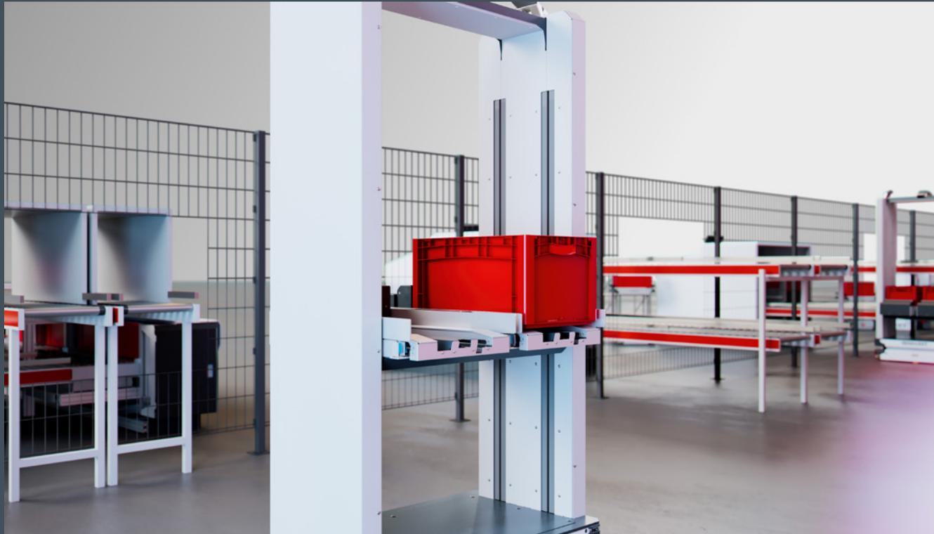
Das modulare Fahrerlose Transportsystem GEBHARDT KARIS® Flow eignet sich für den automatisierten Materialtransport in Produktionsumgebungen und Lagern. Durch die Kombination eines Hubmasts mit einem doppelten Lastaufnahmemittel, das über eine Greiffunktion verfügt, bietet GEBHARDT KARIS® Flow eine Reihe von herausragenden Merkmalen und Vorteilen.
