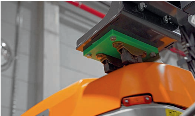
Automatisches Ladesystem: Bei Bedarf, oder wenn keine Fahraufträge anstehen, fährt der FM-X iGo die Ladestation automatisch an
