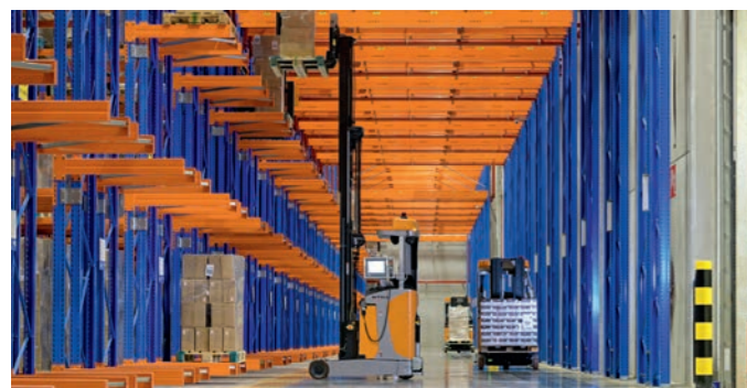
Für präzises und effizientes Palettenhandling auch in den obersten Regalfächern ist der FM-X iGo systems mit einem Pallet Positioning Sensor ausgestattet
