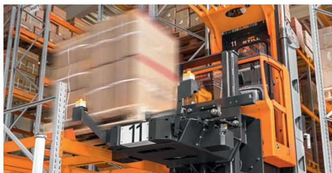
Für maximale Lagerverdichtung ist der MX-X iGo mit einer Teleskoptisch ausgestattet
