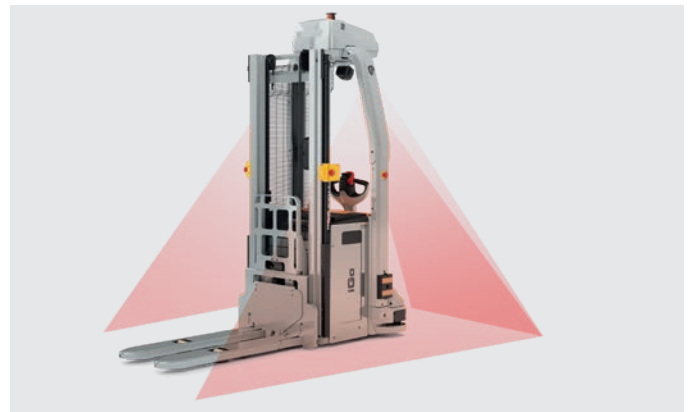
Zuverlässige Kollisionsvermeidung mit zusätzlichen Sensoren zur Erkennung von Hindernissen im Fahrzeugumfeld
