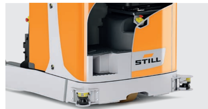
Beste Personensicherheit dank zuverlässiger 360-Grad-Sicherheitslaser am Fahrzeug
