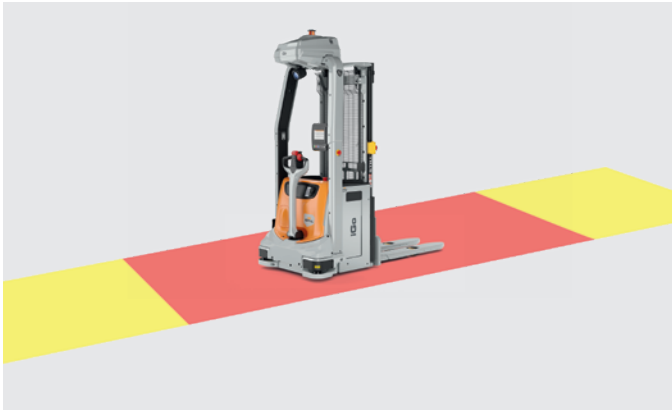
Dynamische Sicherheitsfelder um das Fahrzeug sorgen für maximale Sicherheit und Kollisionsvermeidung: Anpassung der Fahrgeschwindigkeit in Echtzeit in Abhängigkeit vom Kurvenradius
