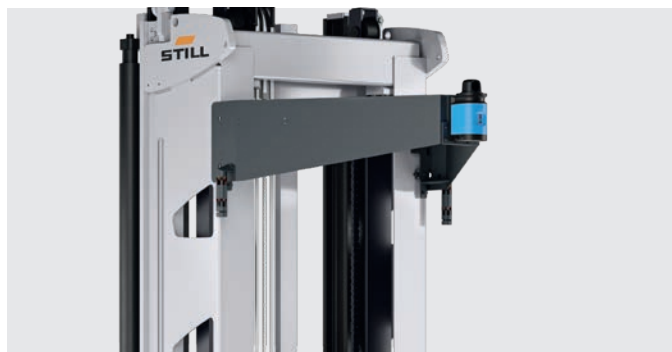
Der sensible Navigationslaser im oberen Fahrzeugbereich ermöglicht höchste Präzision, Effizienz und Sicherheit
