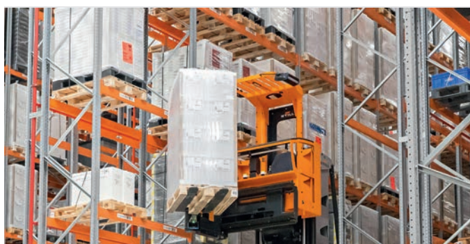
Flexibles Ein- und Auslagern auf beiden Seiten des Regalgangs mithilfe der Schwenkschubgabel
