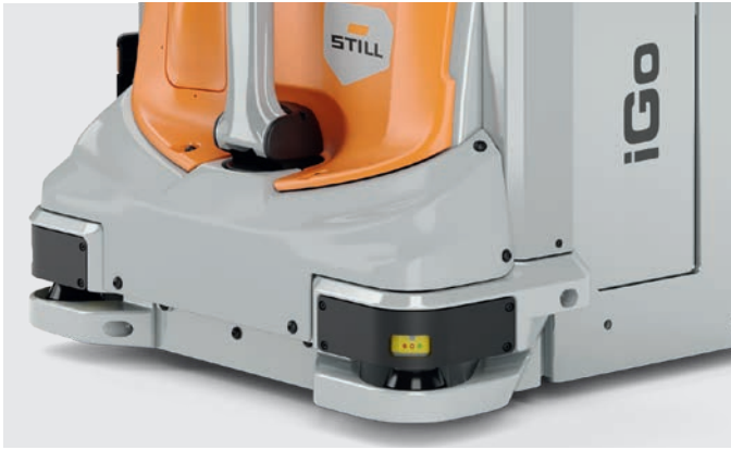
Beste Personensicherheit dank zuverlässiger 360-Grad-Sicherheitslaser am Fahrzeug
