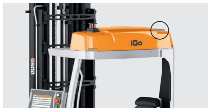
Automatisches Opportunity Charging über die am Fahrerschutzdach befindlichen Ladkontakte für einen ganzheitlich automatisierten Prozess
