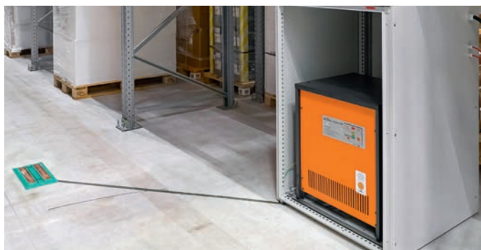
Ladekontakte im unteren Fahrzeugbereich machen vollautomatisierte Ladeprozesse möglich
