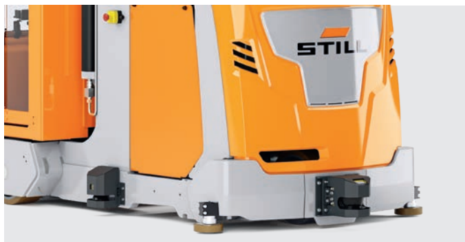
Beste Personensicherheit dank sehr sensibler 360-Grad-Sicherheitslaser am Fahrzeug
