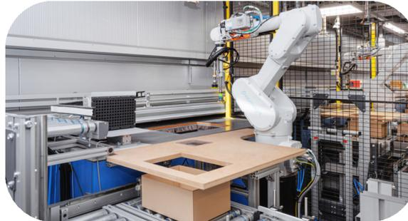
justPack automatisiert den Verpackungsprozess in der Lagerlogistik. Ein KI-gesteuerter Roboterarm mit präziser Greifmechanik erkennt, greift und platziert Artikel sicher in Verpackungen. 3D-Kameras und Sensoren optimieren Bewegungen und minimieren Schäden. Eine Echtzeitschnittstelle zum WMS ermöglicht effizientes Bestandsmanagement bei sicherer Mensch-Roboter-Interaktion.
