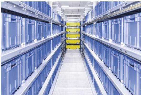
umfasst der Lagerbereich zwei Hallen. Zum einen den manuellen Bereich mit einem vierstöckigen Regalsystem mit 240.000 Lagerplätzen und 1.000 zusätzlichen Palettenplätzen für sehr schwere, große Artikel. Der zweite Lagerabschnitt besteht aus einem Shuttle-Lager mit bis zu 250.000 Lagerplätzen. Auf einer Grundfläche von 39 x 46 Metern befinden sich hier zehn Gassen und 22 Ebenen. Dort werden bis zu 200.000 Artikel gelagert.
